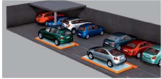
شکل ۵- سامانه پازلی در سطح
