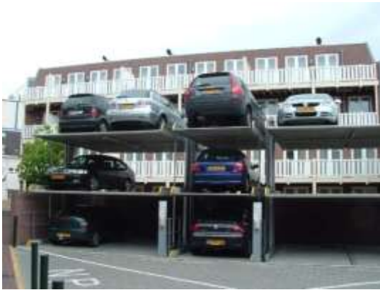
شکل ۶- سامانه پازلی طبقاتی با حرکت عمودی - افقی
