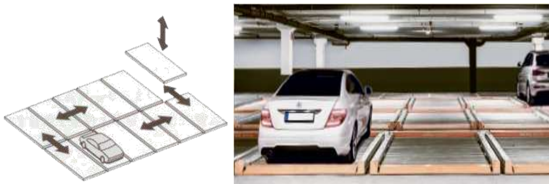
شکل ۴- سامانه چرخشی در سطح
